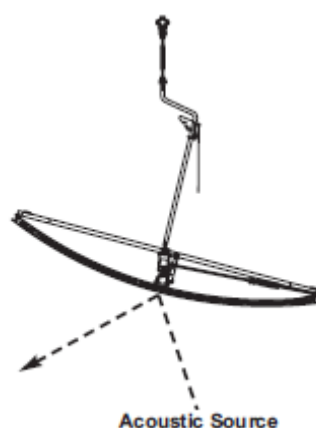
天井音響反射板の音源位置による角度調整
