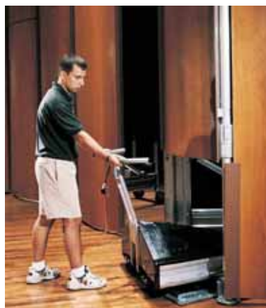
エア-運搬機での移動
