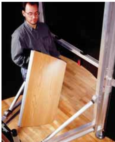
タワーパネルの取り外し
